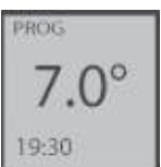
Nach Einstellung einer frostfreien Temperatur (7°C), zeigt der Bildschirm bei Wechsel in den Programmierbereich im ECO-Modus 6°.0 an (*automatische Senkung um 1°C*).
