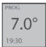
Jeżeli ustalona została temperatura ochrony przed zamarzaniem (7°C), podczas przechodzenia do zakresu programowania w trybie EKO na ekranie wyświetlana jest wartość 6.0° (automatyczne obniżenie o 1°C).
